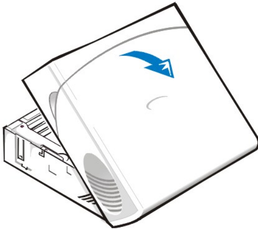
Figura 2. Rimozione del coperchio del computer a profilo basso
