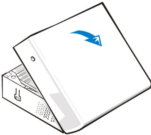
Figura 2. Rimozione del coperchio del computer a profilo basso
